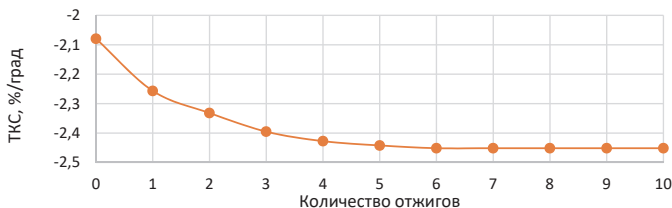
Рис. 4. Зависимость ТКС от количества циклов отжигов (при температуре 25°C)
