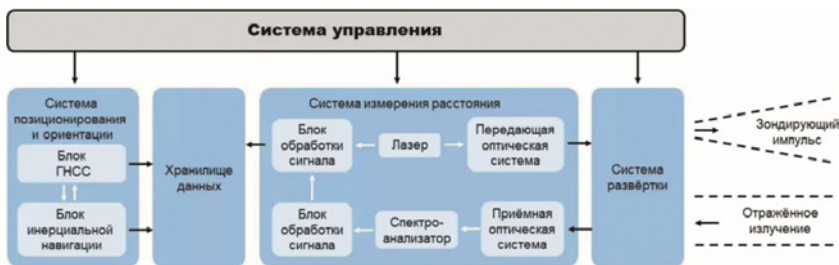
Рис. 1. Схема разработанной системы [3]
