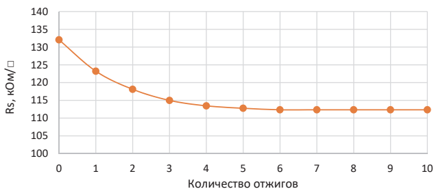
Рис. 3. Зависимость сопротивления R_s от количества циклов отжига
