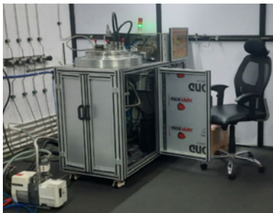
Рис. 1. Установка CVD-синтеза Alkion (слева), рост монокристаллических алмазных слитков (справа)
