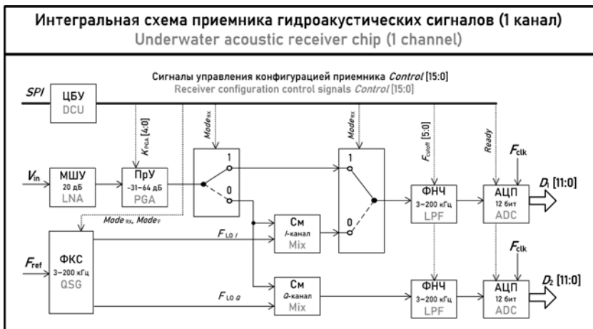
Рис. 1. Структурная схема канала приемника
