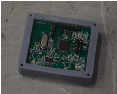
Рис. 2. Позиционирование модуля внутри корпуса прототипа изделия
