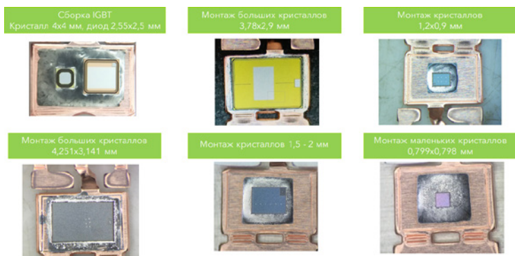
Рис. 2. Силовые кристаллы различных размеров, смонтированные в автоматическом режиме
