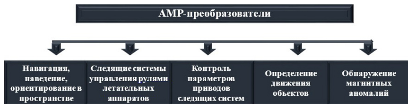
Рис. 1. Структура деления и сферы применения анизотропных магниторезистивных сенсоров
