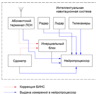
Рис. 1. Схема интеллектуальной навигационной системы БТС
