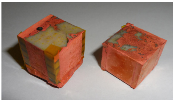
Рис. 1. Образцы тестовых микросборок после металлизации (неметаллизированные участки вокруг боковых ребер, закрытые от металлизации, служат для обеспечения последующего совмещения с фотошаблоном коммутации)
